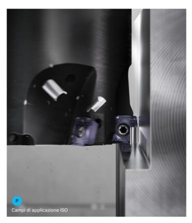
Qualità GC1230 per la fresatura dell'acciaio con utensili multitaglienti
